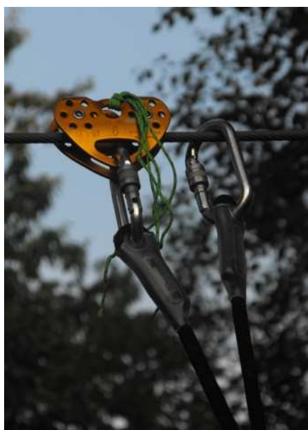
Zdjęcie nr 1. Niepoprawne wpięcie bloczka.
