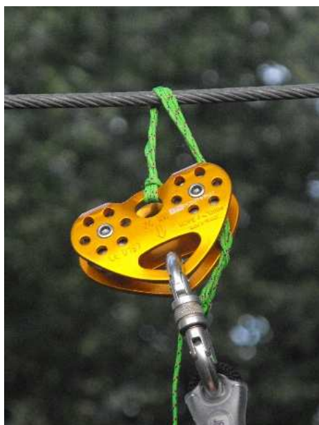
Zdjęcie nr 5. Poprawne wpięcie bloczka do liny asekuracyjnej.
