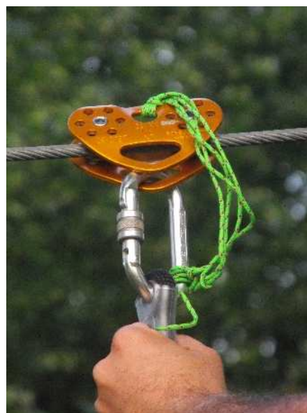
Zdjęcie nr 2. Niepoprawne wpięcie bloczka.
