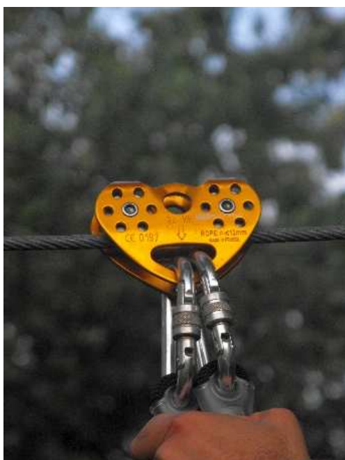
Zdjęcie nr 5. Poprawne wpięcie bloczka do liny asekuracyjnej.
