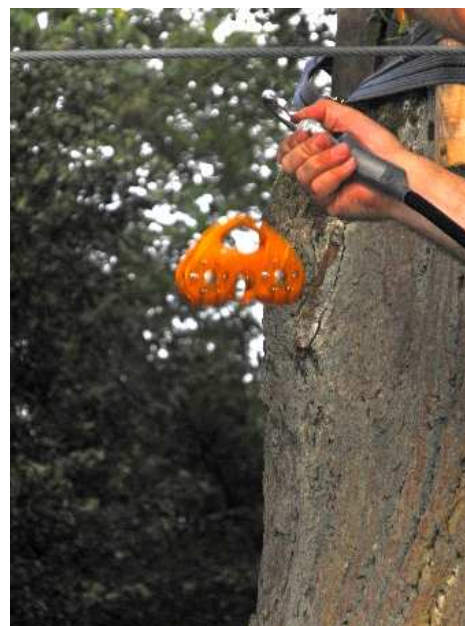
Zdjęcie nr 4. Próba wpięcia zakończona upadkiem bloczka w przypadku braku sznureczka..
